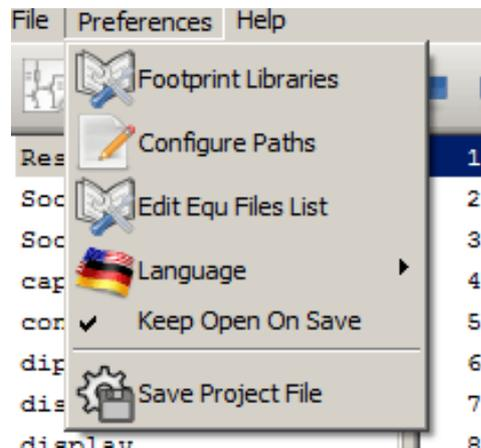
CvPcb 可以在保存封装关联关系后自动关闭或手动关闭。
