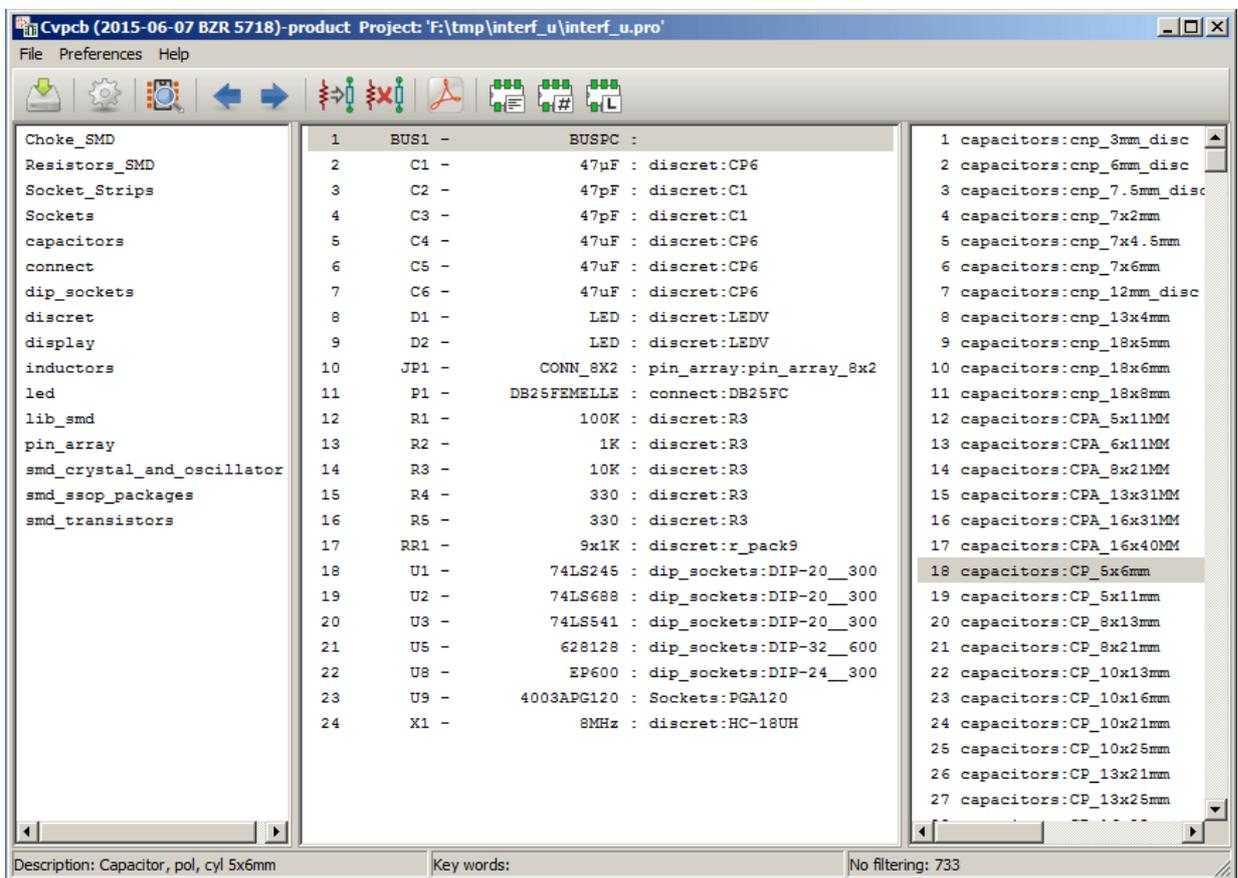
在主界面中, 左窗格包括了所有与项目关联的可用的封装库文件名列表; 中间窗格包括了从网络文件中读入的所有元器件列表; 右窗格包括了所有从与项目关联的封装库中加载的可用的封装列表。如果没有加载网络文件, 那么元器件列表将是空的; 类似的, 如果没有找到可用的封装库, 那么位于右侧的封装列表也将是空的。
