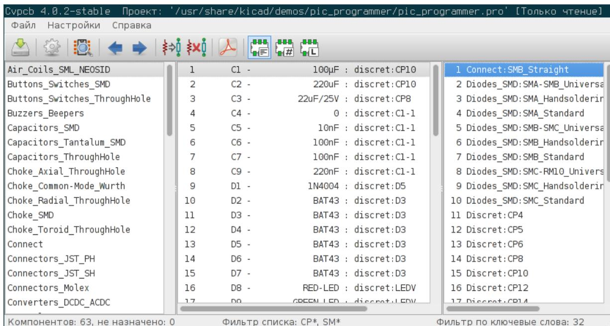
На левой панели содержится список доступных библиотек посадочных мест связанных с проектом. На центральной панели содержится перечень компонентов загруженных из файла списка цепей. Правая панель содержит список доступных посадочных мест из библиотек посадочных мест проекта. Если файл списка цепей отсутствует - перечень компонентов будет пуст, также, панель посадочных мест будет пустой, если не найдётся ни одной библиотеки.
